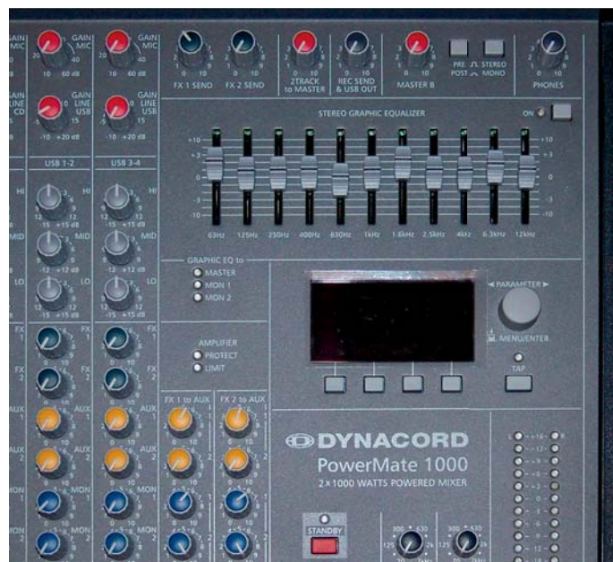
Powermikser został wyposażony w jedenastopunktowy korektor graficzny, który można wyłączyć za pomocą dedykowanego przycisku.
