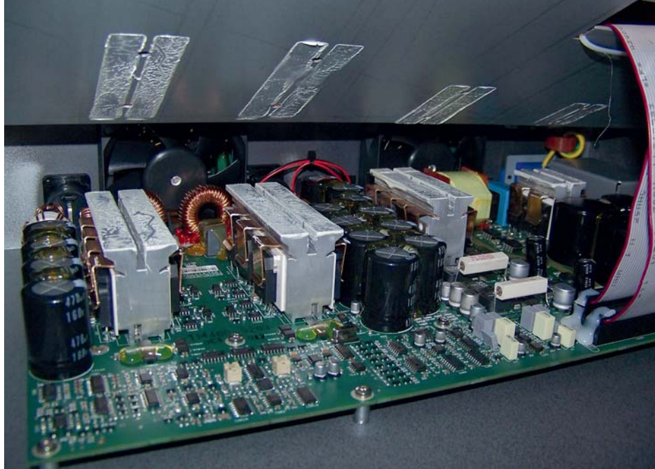
W dolnej części obudowy znajdują się układy mocy, które są dokładnie oddzielone za pośrednictwem osłony z blachy stalowej.
